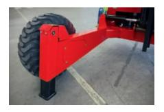
Stützen als Standardausrüstung für alle Modelle für bessere Stabilität.
