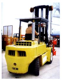
Da sich die gelenkten Räder hinten befinden, schwenkt der Gabelstapler hinten seitlich aus. Hieran muss der Gabelstaplerfahrer beim Rangieren und bei Kurven fahrt denken.
