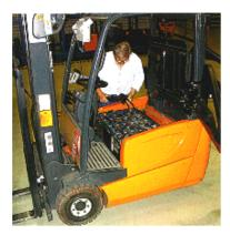
Beim Laden von Elektrobatterien muss für eine gute Entlüftung im Bereich der Ladestation gesorgt sein. Abdeckungen an Batterie-Einbauräumen müssen daher während des Ladevorgangs geöffnet bzw. abgenommen sein.
