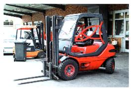
Verlässt der Fahrer den Gabelstapler sollte er nicht vergessen, die Feststellbremse anzuziehen, den Antrieb stillzusetzen, die Gabelzinken mit den Spitzen bis auf den Boden abzusenken und erforderlichenfalls Vorlegeklötze anzulegen. Er sollte auch daran denken, keine Verkehrswege oder Notausgänge zu blockieren.
