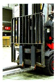
Der Gabelstapler ist mit einem Lastschutzgitter ausgerüstet. Dadurch kann sich die Last auf der Rückseite gegen das Lastschutzgitter abstützen. So schützt das Lastschutzgitter zusätzlich davor dass Teile der Last beim Stapeln auf den Fahrer herabfallen.
