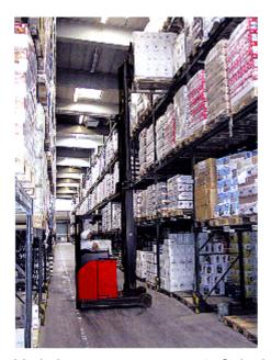
Verkehrswege müssen stets freigehalten werden, damit sie jederzeit gefahrlos befahren werden können. Eine gute Beleuchtung der Verkehrswege ist in Lagerhallen für einen sicheren Gabelstaplerverkehr wichtig.
