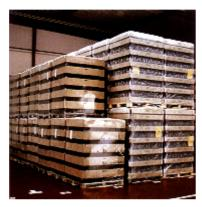
Eine weit verbreitete Methode, die Last gegen Verschieben und Herabfallen zu sichern, ist das Einschrumpfen mit Folie.
