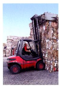
Bei Verwendung von Anbaugeräten verringert sich in der Regel die Tragfähigkeit des Gabelstaplers.
