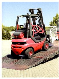
Gabelstapler mit Flüssiggasantrieb dürfen nicht in Räumen unter Erdgleiche untergestellt werden. Gleiches gilt für Räume, in denen sich Gruben, Schächte, Kanäle oder ähnliche Vertiefungen befinden.
