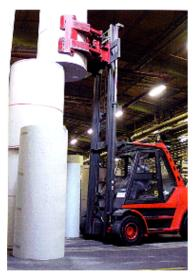
Beim Aufeinanderstapeln von Lasten ist es wichtig, dass der Untergrund horizontal, eben und ausreichend tragfähig ist und die Art der Last einen senkrechten Stand des Stapels gewährleistet. Die Lasten müssen so stabil sein, dass sie das Gewicht darüber liegender Lasten tragen können.
