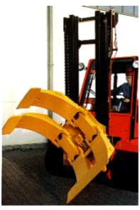
Bei Verwendung von Anbaugeräten müssen am Gabelstapler hierauf abgestimmte Tragfähigkeitsangaben vorhanden sein. Es muss deutlich erkennbar sein, zu weichem Anbaugerät die Tragfähigkeitsangaben gehören. Ein entsprechendes Fabrikschild muss auch am Anbaugerät angebracht sein.
