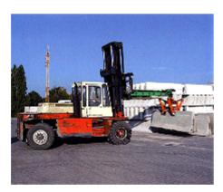
Bei klemmenden Anbaugeräten kommt es darauf an, dass der vorgegebene Greifbereich eingehalten wird.
