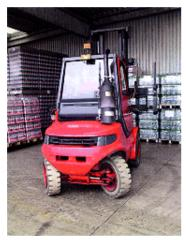
Sind Diesel-Gabelstapler mit einer wirksamen Abgasreinigung ausgerüstet, dürfen sie auch in ganz oder teilweise geschlossenen Räumen eingesetzt werden
