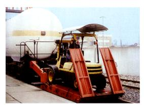
Einsatz eines Rangiergerätes beim Verschieben von Kesselwaggons: Da der Fahrer beim Bewegen von Waggons vom Fahrersitz des Staplers aus den Fahrbereich nicht einsehen kann, muss er bei seiner Arbeit durch einen Einweiser unterstützt werden.
