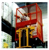
Arbeitsbühne für Arbeiten an Regalen oder in Schmalgängen von Regalanlagen: Ein Auf- und Abwärtsfahren der Arbeitsbühne ist nur bei geschlossener Umzäunung möglich. Die Fahrbewegung wird automatisch unterbrochen, sobald ein Seitenfenster oder die Tür geöffnet wird.
