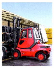
Die Kabine schützt den Gabelstaplerfahrer vor Witterungseinflüssen. Wo Gabelstapler üblicherweise bei "Wind und Wetter" im Freien eingesetzt werden, sollte man auf einen allseitigen Schutz nicht verzichten.
