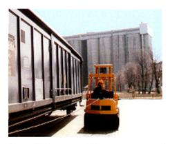
Beim Ziehen von Waggons muss der Gabelstapler mit einer geeigneten Slip-Kupplung ausgerüstet sein. Der Gabelstapler muss seitlich von dem zu ziehenden Waggon fahren, damit der Fahrer die Bewegung des Waggons beobachten kann.
