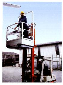
Arbeitsbühne für Montage-, Instandsetzungs- oder Wartungsarbeiten: für Arbeiten in Schmalgängen von Regalanlagen und an Regalen ist diese Bühne nicht zulässig.
