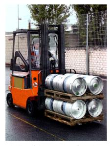
Die Tragfähigkeit des Gabelstaplers darf niemals überschritten werden. Das höchstzulässige Gewicht der Last in Abhängigkeit vom Lastschwerpunktabstand ist auf dem Tragfähigkeitsschild angegeben. Daher muss der Gabelstaplerfahrer das Gewicht der Last und den Lastschwerpunkt kennen.
