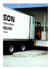
Der Gabelstaplerfahrer befährt einen Lastkraftwagen. Bevor er dies tut, muss er sich vergewissert haben, dass die Bremsen des Lastkraftwagens festgestellt und die Vorlegeklötze angelegt sind.
