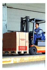
Auf Rampen ist stets mit größter Vorsicht zu fahren; denn für den Gabelstapler besteht Absturzgefahr wenn er zu nahe an die Rampenkante gerät. Breite Rampen helfen, die Absturzgefahr zu verringern.
