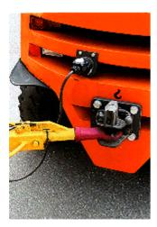
Wenn mit einem Gabelstapler Flurförderzeuganhänger gezogen werden sollen, muss der Gabelstapler mit einer Anhängekupplung ausgerüstet sein, von der sich der Anhänger nicht unbeabsichtigt lösen kann.
