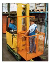
Arbeitsbühne für Arbeiten an Regalen oder in Schmalgängen von Regalanlagen: Hub- und Fahrbewegungen können mit dieser Arbeitsbühne nur bei gleichzeitiger Betätigung der in der Arbeitsbühne untergebrachten Zweihand-Zustimmungstaster ausgeführt werden.
