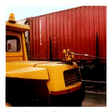
Mit Hilfe eines Seilzuges kann der Fahrer das Zugseil des Waggons jederzeit von der Slip-Kupplung lösen.
