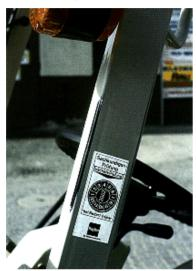
Gabelstapler müssen nach Bedarf jährlich jedoch mindestens einmal, durch einen Sachkundigen geprüft werden. Die Prüfplakette weist an diesem Gabelstapler darauf hin, wann die nächste Prüfung fällig ist.
