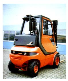
Explosionsgefährdete Bereiche dürfen nur mit explosionsgeschützten Gabelstaplern befahren werden.
