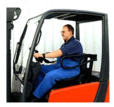
Dieser Türbügel schließt sich kraftbetrieben, sobald die Feststellbremse gelöst wird. Der sicherheitstechnische Vorteil liegt darin, dass sich beim Aussteigen der Türbügel nur öffnen lässt, wenn zuvor die Feststellbremse betätigt wurde.
