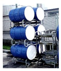
Für den Transport horizontal liegende Fässer gibt es speziell entwickelte Fasspaletten. Die Fässer liegen dabei in Mulden, die der Fassrundung angepasst sind und dadurch verhindern, dass die Fässer in Bewegung geraten und von der Palette abrollen können.
