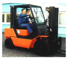
Zur Mitnahme einer zweiten Person ist der Gabelstapler mit einem Beifahrersitz, einer weiteren Fahrerrückhalteeinrichtung und zusätzlich mit einem Haltegriff ausgerüstet.
