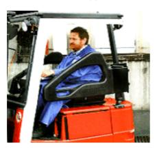
Am Fahrerplatz anzubringendes Bügelsystem, das ähnlich einer Tür beim Besteigen bzw. Verlassen des Gabelstaplers zu öffnen bzw. zu schließen ist. Da die Bügeltüren maximal 90° geöffnet werden können, werden sie vom Fahrer vor Antritt der Fahrt zwangsläufig geschlossen.
