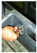
Der Gabelstaplerfahrer darf nicht vergessen, den Schlüssel aus dem Schalt- oder Anlassschloss abzuziehen und mitzunehmen, wenn er den Gabelstapler verlässt.
