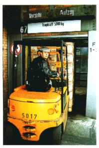
Ein Gabelstapler fährt in die Aufzugskabine ein. Der Fahrer darf aber während der Aufzugsfahrt in nicht ganz geschlossenen Kabinen niemals auf dem Gabelstapler sitzen bleiben. Sein Platz ist an der Steuerung des Aufzugs.
